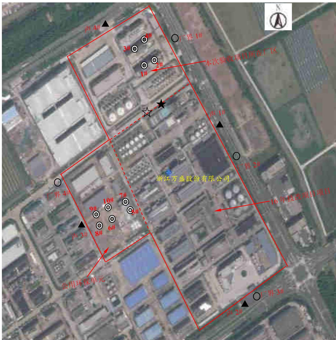
注: ⊙为有组织废气监测点位, ○为厂界无组织废气监测点位; ★为废水监测点位, ☆为雨水监测点位, ▲为厂界噪声监测点位。
